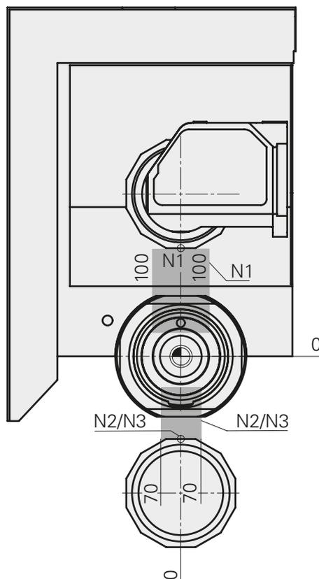
**Arbeitsraum INDEX G400.2, INDEX G500****Werkzeugträger oben XYZ, VDI40 mit 12 Stationen (SW380)****Werkzeugträger unten XZ, VDI40 mit 18 Stationen (SW480)****Haupt-/Gegenspindel, Spindeldurchlass D120mm, Drehlänge 1600mm**
