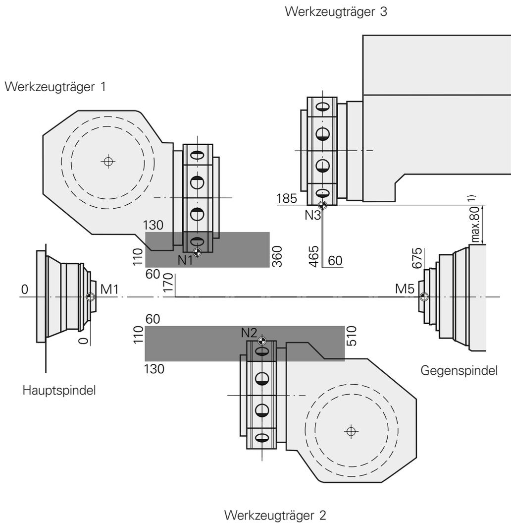
1) maximale Werkzeuglänge auf Station 1, wenn die Gegenspindel ein Werkstück an der Hauptspindel abholt
