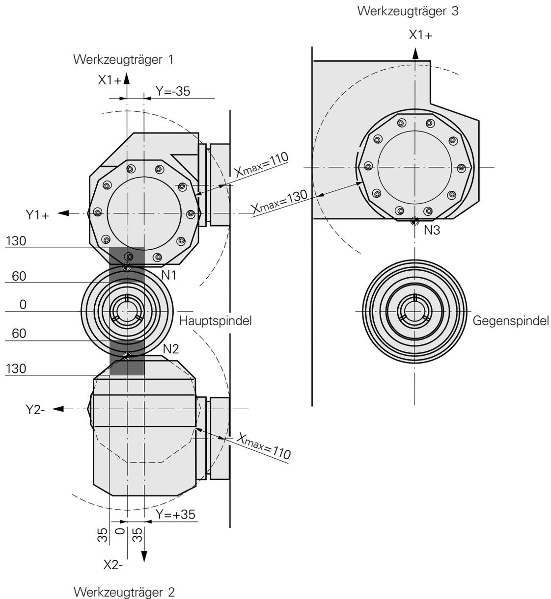
**Schwenkbereich Werkzeugträger INDEX C100**
