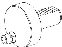
**10677850 Tubulure de lubrifiant**
