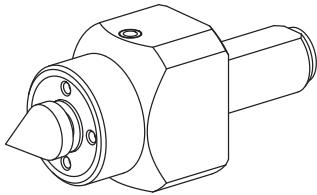
**11042772 Support de pointe de guidage, sur ressort, rotative,
