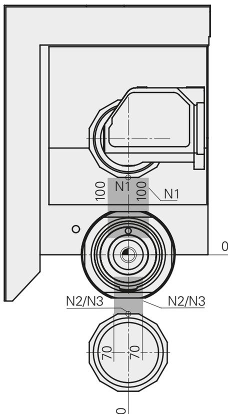
**Zone d'usinage des INDEX G400.2, INDEX G500****Unité d'usinage supérieure XYZ, VDI40, 12 postes (SW380)****Unité d'usinage inférieure XZ, VDI40, 18 postes (SW480)****Broche principale/contrebroche, passage de broche D120mm, long. chariotage 1600mm**
