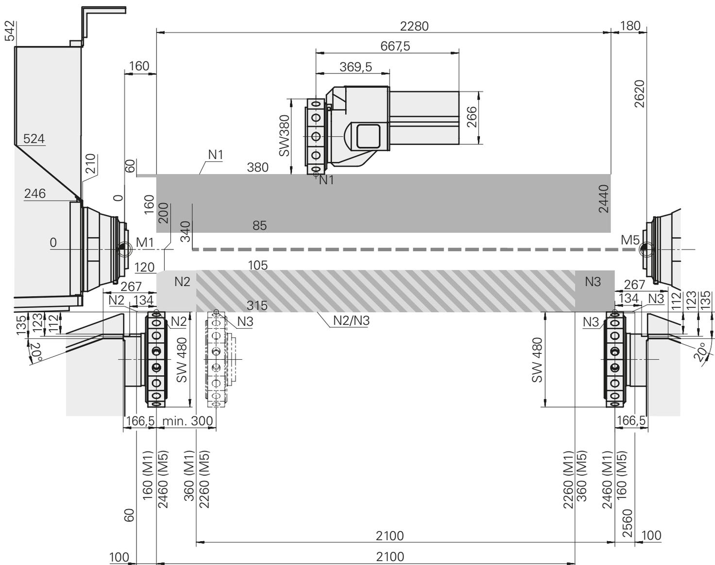
**Zone d'usinage des INDEX G400.2, INDEX G500****Unité d'usinage supérieure XYZ, VDI40, 12 postes (SW380)****Unité d'usinage inférieure XZ, VDI40, 18 postes (SW480)****Broche principale/contrebroche, passage de broche D120mm, long. chariotage 2300mm**
