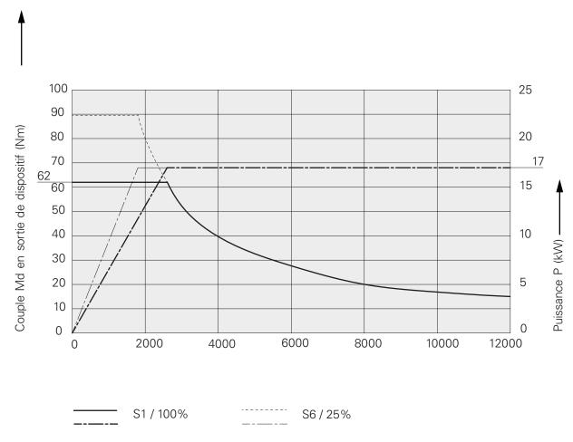
Vitesse de rotation n1 en sortie de dispositif (min-1)
