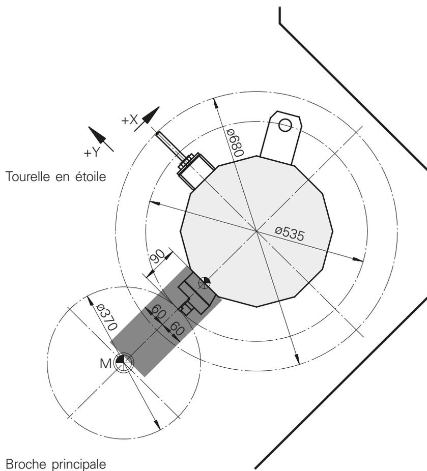
**Zone d'usinage des INDEX B400, TRAUB TNA400** jusqu'au n° de machine 120x0099
