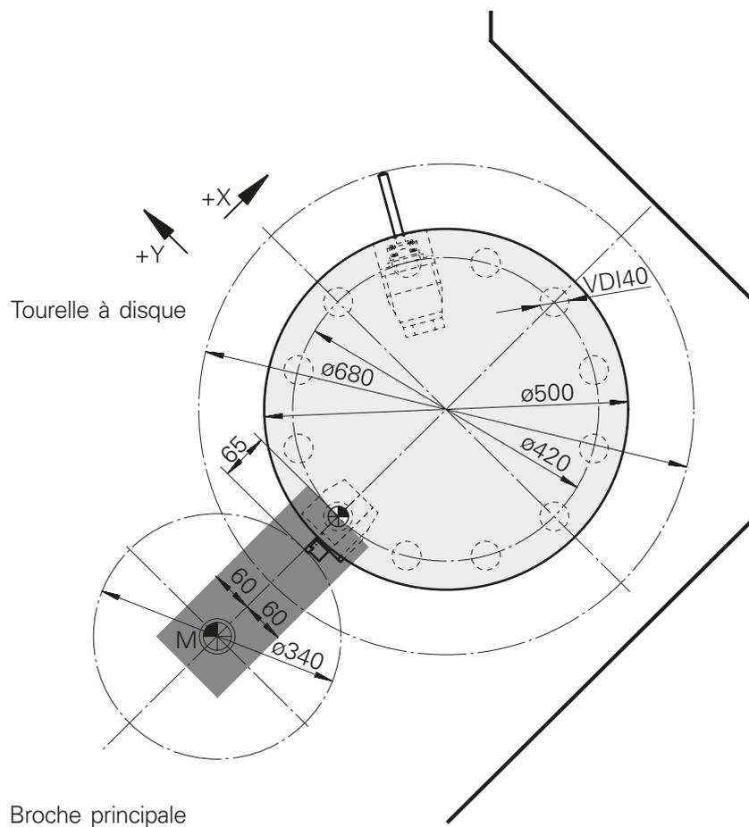
**Plage de révolution des INDEX B400, TRAUB TNA400** jusqu'au n° de machine 120x0099
