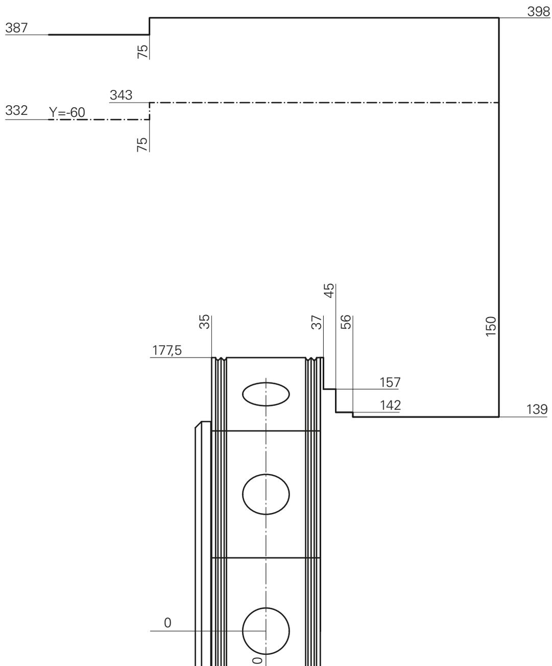
**Plage de révolution des INDEX B400, TRAUB TNA400** jusqu'au n° de machine 120x0099
