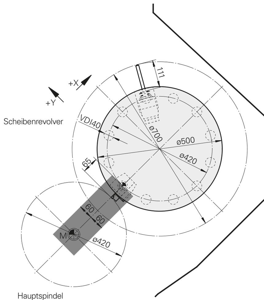
**Schwenkbereich INDEX B400** Maschinen Nr. 12010100 bis 12010118
