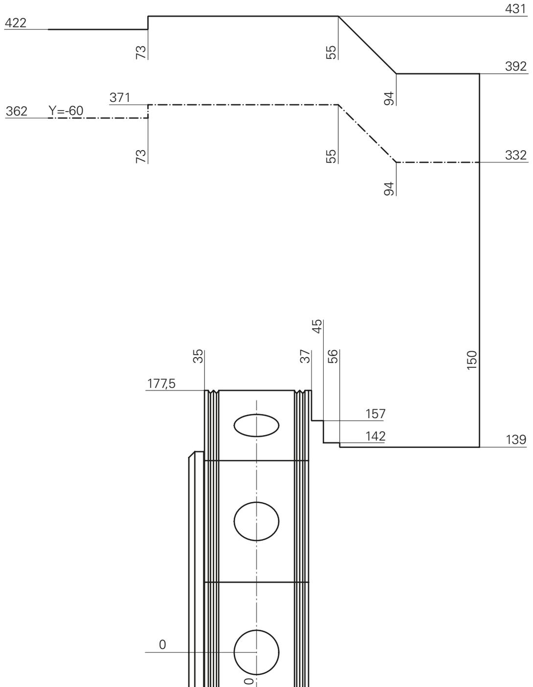
**Schwenkbereich INDEX B400** Maschinen Nr. 12010100 bis 12010118
