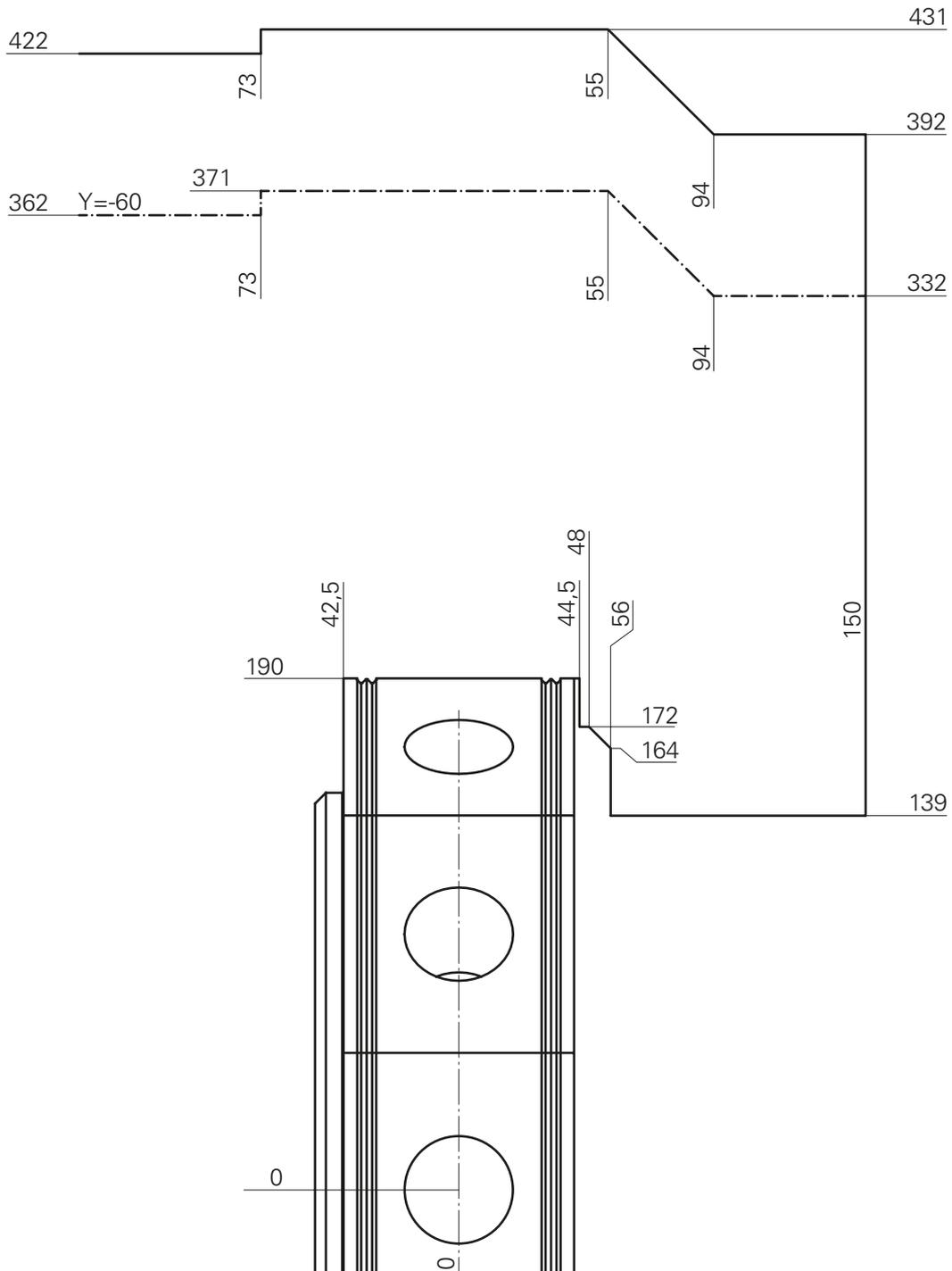
**Schwenkbereich INDEX B400** Maschinen Nr. 12010100 bis 12010118
