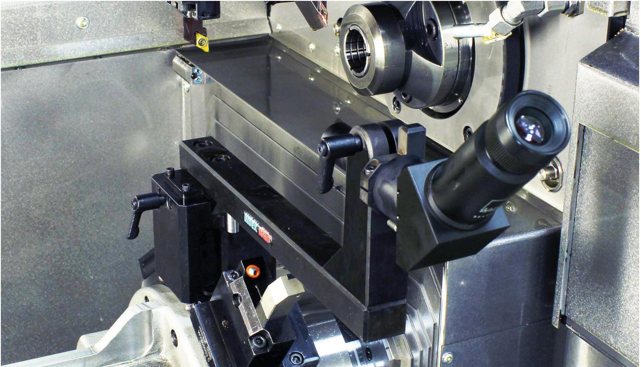
Ce dispositif de mesure automatique des outils permet de transférer directement dans la commande de la machine les coordonnées des plaquettes (X et Z) pour tous les postes de porte-outils. Tout cela se passe dans la machine. Ainsi est-il possible d'éviter les incertitudes de mesure entre banc de pré-réglage et interface du porte-outil.
