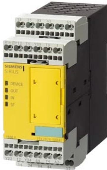
!!! Auslaufprodukt !!! Die Nachfolge-Produktreihe ist 3SK2 (siehe FAQ 109741483) SIRIUS Sicherheitsschaltgerät mit Relais-Freigabekreisen (FK) DC 24 V, 45 mm Federzugklemme FK unverzögert: 4 S FK verzögert: 0 MK: 3 8-Funktionen-Schalter Grundgerät maximal erreichbarer PL nach EN 13849-1: e maximal erreichbarer SIL nach IEC 61508: 3
