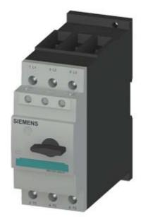
Leistungsschalter Baugröße S2 für den Motorschutz, CLASS 10 A-Auslöser 28...40 A N-Auslöser 520 A Schraubanschluss mit integriertem Hilfsschalter !!! Auslaufprodukt !!! Nachfolger ist SIRIUS 3RV2 Präferierte Nachfolgertype ist >>3RV2031-4UA15<<
