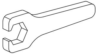
Werkzeug für Spannzangen
