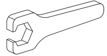
Werkzeug für Spannzangen
