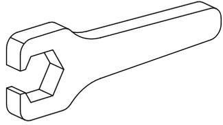
Werkzeug für Spannzangen
