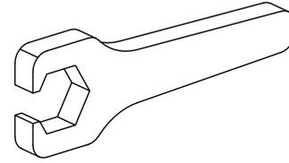
Werkzeug für Spannzangen
