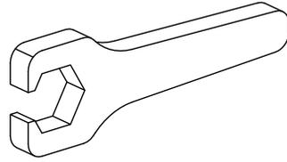
Werkzeug für Spannzangen
