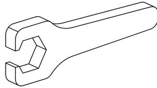
Werkzeug für Spannzangen
