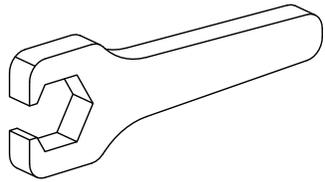
Werkzeug für Spannzangen
