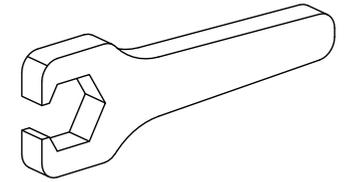
Werkzeug für Spannzangen
