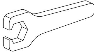
Werkzeug für Spannzangen
