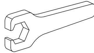
Werkzeug für Spannzangen
