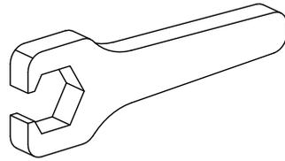
Werkzeug für Spannzangen
