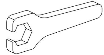
Werkzeug für Spannzangen
