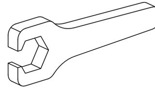
Werkzeug für Spannzangen
