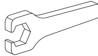
Werkzeug für Spannzangen
