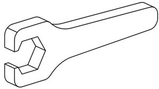
Werkzeug für Spannzangen
