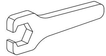
Werkzeug für Spannzangen
