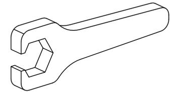
Werkzeug für Spannzangen
