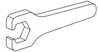
Werkzeug für Spannzangen
