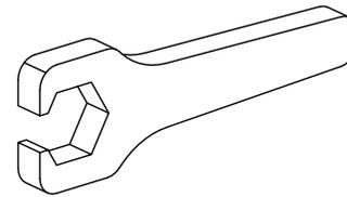
Werkzeug für Spannzangen
