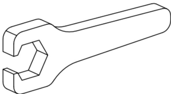
**Werkzeug für Spannzangen**
