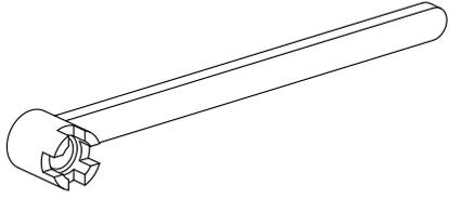
Werkzeug für Spannzangen
