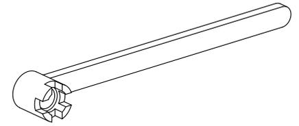
Werkzeug für Spannzangen
