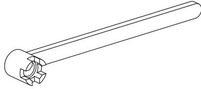
Werkzeug für Spannzangen
