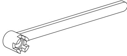
Werkzeug für Spannzangen
