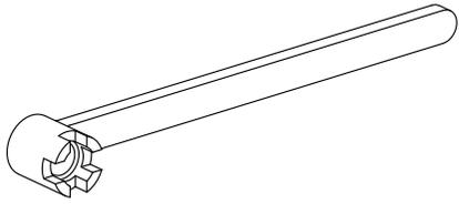
Werkzeug für Spannzangen
