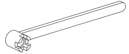
Werkzeug für Spannzangen
