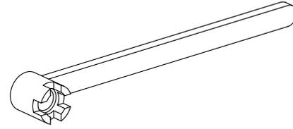
Werkzeug für Spannzangen
