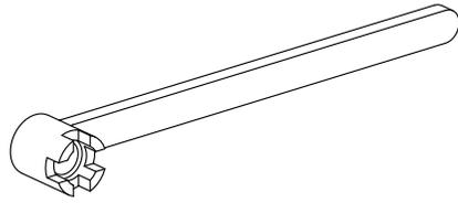
Werkzeug für Spannzangen
