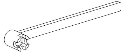
Werkzeug für Spannzangen
