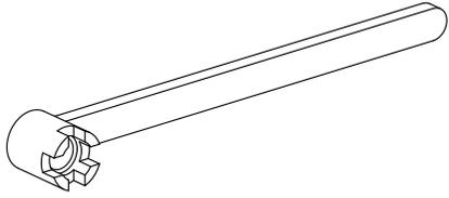
Werkzeug für Spannzangen
