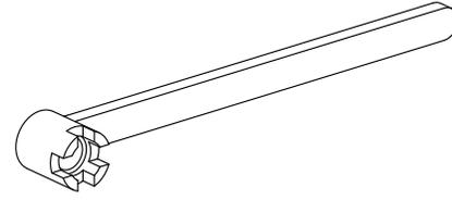
Werkzeug für Spannzangen
