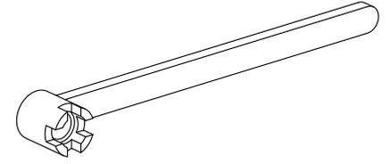
Werkzeug für Spannzangen
