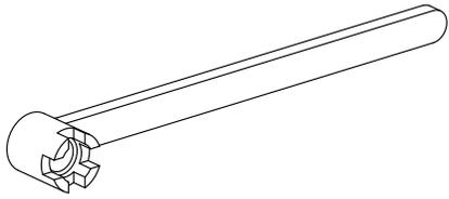
Werkzeug für Spannzangen
