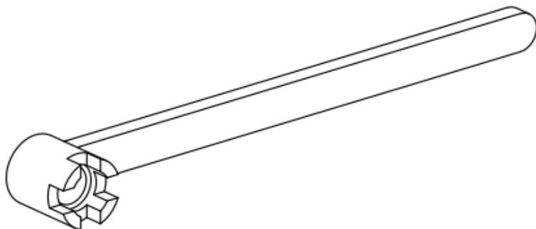
**Werkzeug für Spannzangen**
