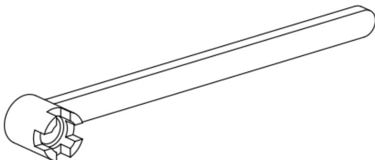
**Werkzeug für Spannzangen**
