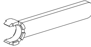
Werkzeug für Spannzangen
