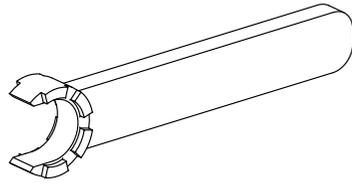
Werkzeug für Spannzangen
