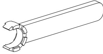
Werkzeug für Spannzangen
