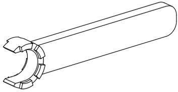
Werkzeug für Spannzangen
