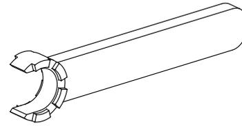
Werkzeug für Spannzangen
