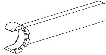
Werkzeug für Spannzangen
