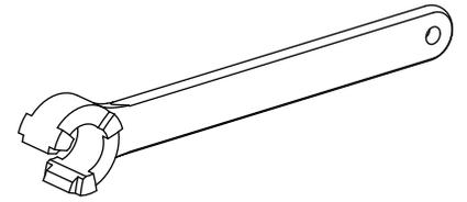
Werkzeug für Spannzangen
