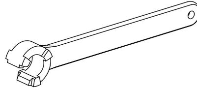
Werkzeug für Spannzangen
