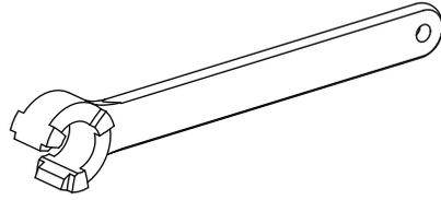
Werkzeug für Spannzangen
