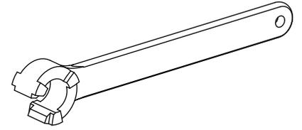
Werkzeug für Spannzangen
