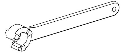
Werkzeug für Spannzangen
