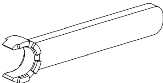
**Werkzeug für Spannzangen**
