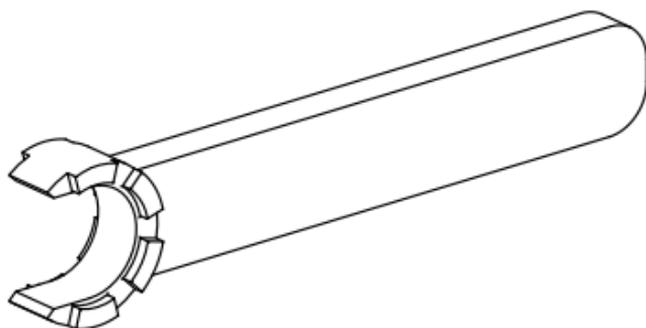
**Werkzeug für Spannzangen**
