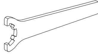
Werkzeug für Spannzangen
