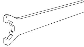
Werkzeug für Spannzangen
