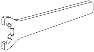
Werkzeug für Spannzangen
