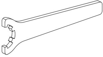
Werkzeug für Spannzangen
