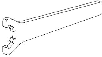
Werkzeug für Spannzangen
