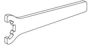
Werkzeug für Spannzangen
