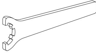
Werkzeug für Spannzangen
