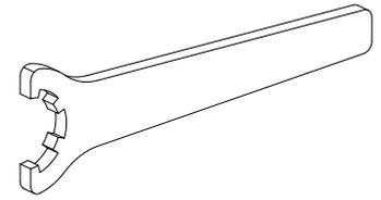
Werkzeug für Spannzangen
