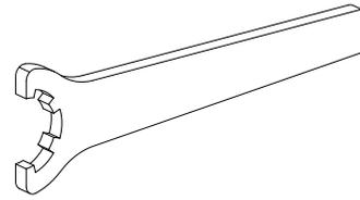
Werkzeug für Spannzangen
