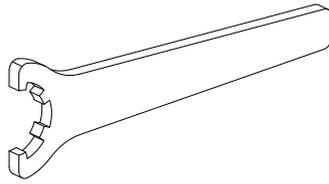
Werkzeug für Spannzangen
