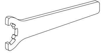
Werkzeug für Spannzangen
