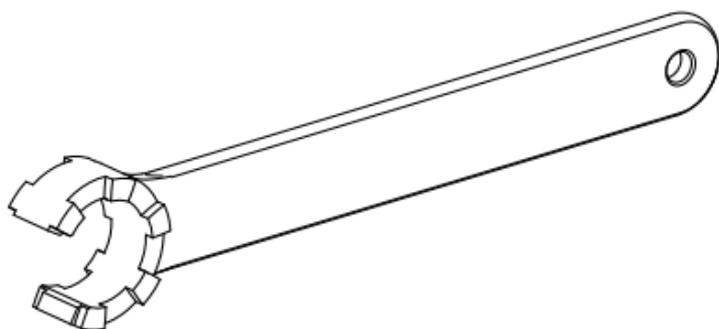
**Werkzeug für Spannzangen**
