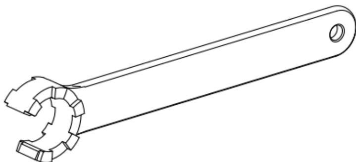
**Werkzeug für Spannzangen**
